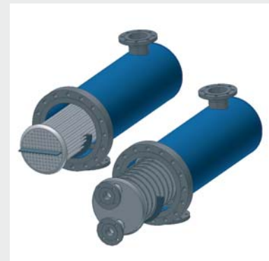
Bild 3: Schematische Darstellung des Ersetzens eines Rohrbündels durch Plattenpakete.
